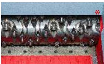
Versione rotore 7 (Ø della lama 40 mm)
