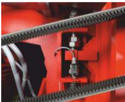
Sicherheitspaket mit Getriebeendschalter und Reversierzähler
