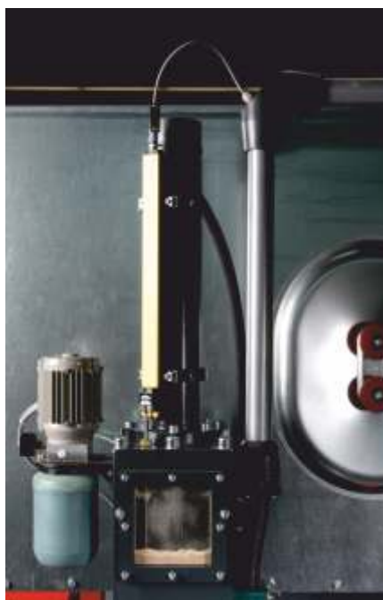
Wegemeßsystem zur Steuerung der Abläufe des Zylinders und der Pressmatrize. Daneben die Zentralschmieranlage
