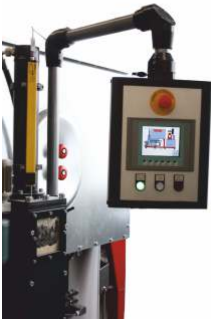
Kontrollpanel zur Steuerung und Programmierung der Brikettierpresse mittels Touch-Screen
